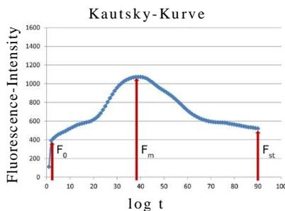
Mit der START-Taste wird die vollautomatische CFD-Messung gestartet. Das Areal auf dem Blatt wird mit Licht angestrahlt und *FloraTest* registriert für 3min bzw. 4min das Fluoreszenzlicht.
